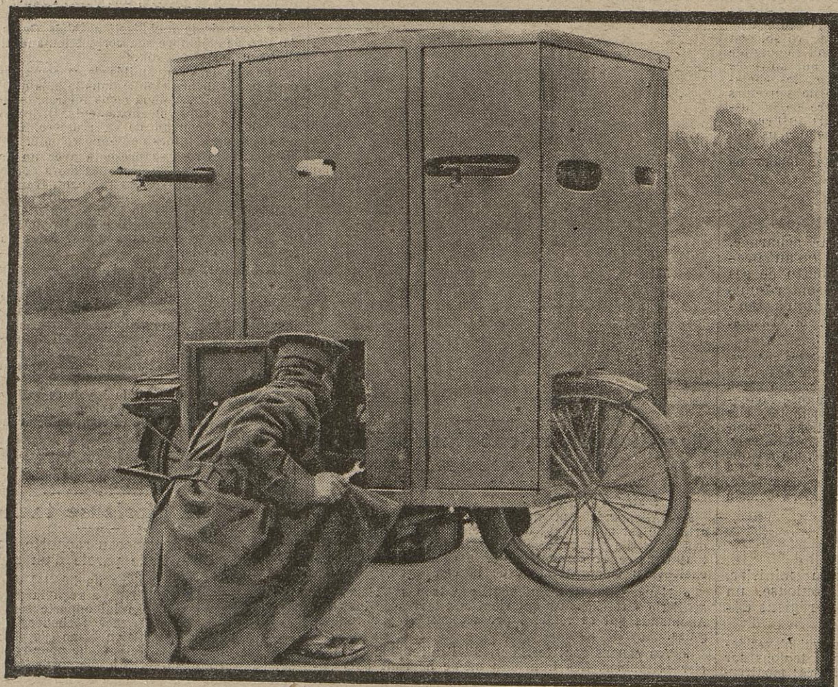
L'armée britannique qui utilise, nous l'avons dit, des voiturettes blindées, emploie encore, pour le service de reconnaissance, des tricars qui, eux aussi, sont protégés contre les balles.
