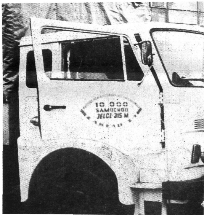
10-tysięczny „Jelcz 315” opuścił taśmę produkcyjną Jelczańskich Zakładów Samochodowych. Jest to 8-tonowa ciężarówka, której seryjną produkcję rozpoczęto przed 4 laty. Od tego czasu stale ją ulepszano i modernizowano, tak że dziś „Jelcz 315” jest pojazdem nowoczesnym, wyposażonym w wysokoprężny silnik „Leylanda”, czteroosobową, klimatyzowaną kabinę kierowcy i hydrauliczne wspomaganie układu kierowniczego. Tegoroczną nowością, obok montażu „Berlietów”, będą „Jelcze 317” — ciągniki siodłowe do przewozu ładunków kontenerowych o ciężarze 28 ton
