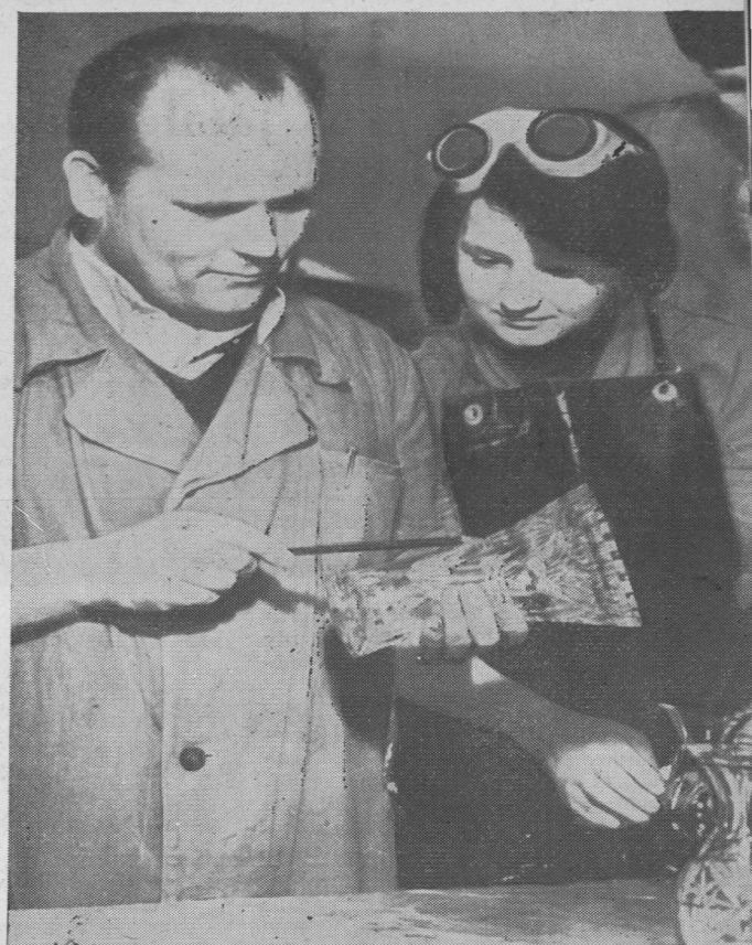
Gdy uczeń zrobił już kompozycję, to nanosi na szkło zasadnicze linie i potem według rysunku zdobi szkło wykonując różne cięcia proste, ukośne, szlify
