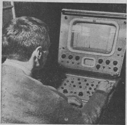
Pulpit kontrolny toru kamerowego z monitorem (część urządzenia studia)
