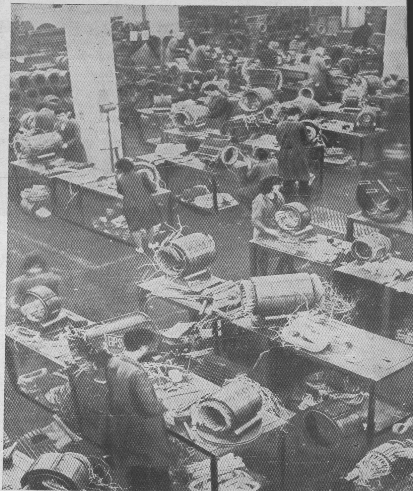
Co roku produkcja „CELMY” wzbogaca się o 50 nowych grup asortymentowych. Na zdjęciu fragment nawijalni silników
