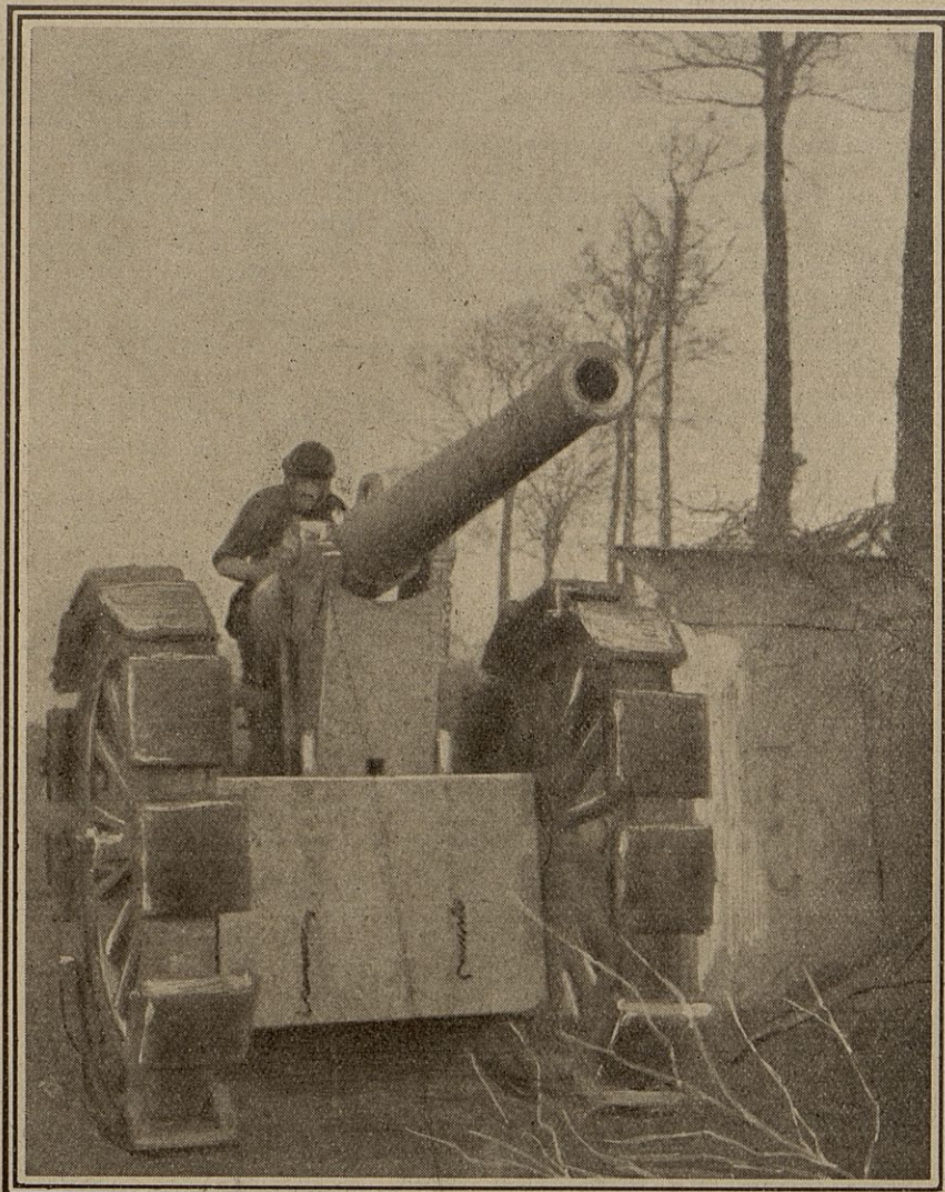
Ces pièces ont un poids considérable et auraient vite fait de défoncer les routes et de s'immobiliser. Pour parer à cet inconvénient, on garnit les roues de patins en bois.
