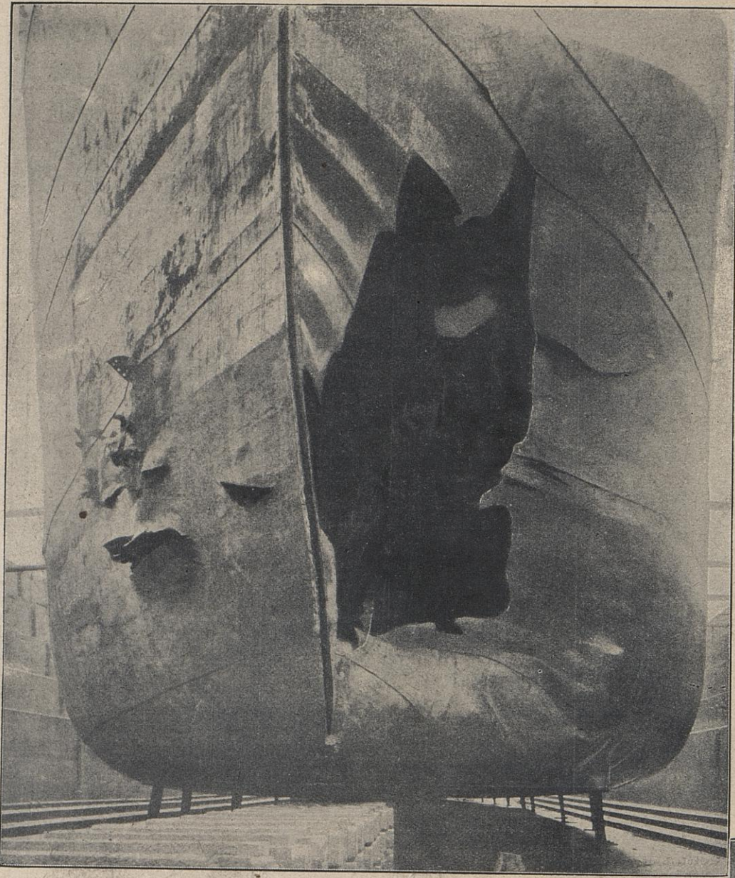
Zu dem Artikel „Torpedoboote“: Ein von einem Torpedo verursachtes Loch. (Nach einer englischen Photographie.)
