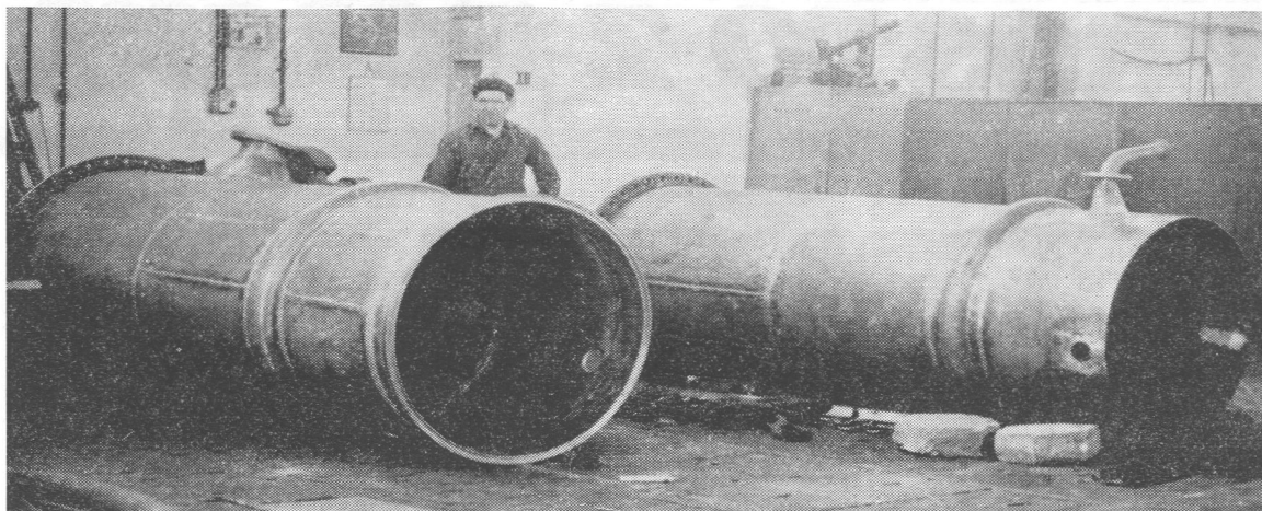
Stożek z miedzi, który jako pierwszy był spawany metodą na zimno w jednej z nyskich fabryk
