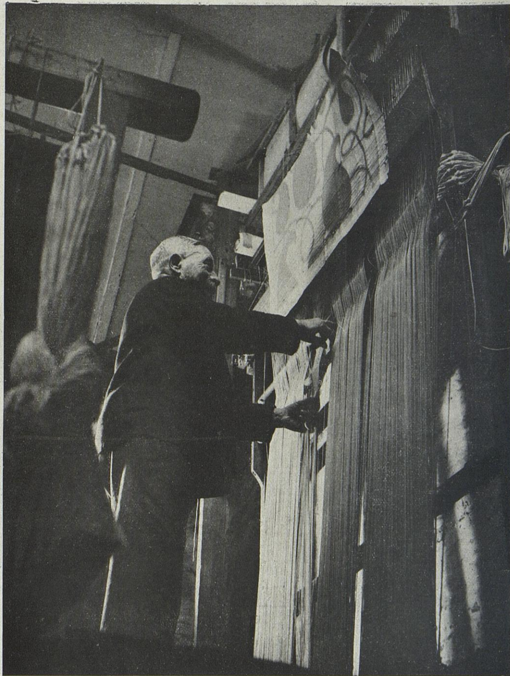
M. Lefèvre « piqueur » semble jouer de la harpe. Quand il aura « lu » son travail, il perforera les bandes.
