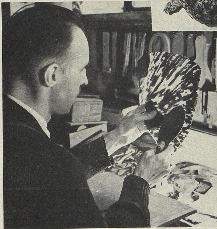
Une opération très délicate: le débitage. L'artisan recherche l'emplacement le plus favorable.
