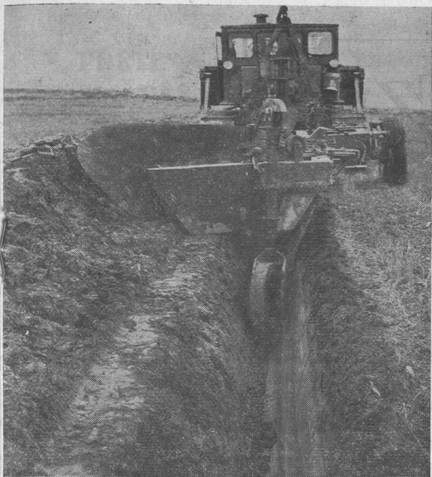
Specjalne maszyny do drażenia rowów wykonują w ciągu jednego dnia tyle, ile 50 ludzi przez tydzień. Potężny traktor zostawia za sobą głęboką bruzdę
