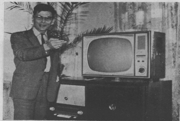
A oto „Nefryt”, przedostatni krzyk mody, własna konstrukcja, pełna automatyzacja, płaska skrzynka i ekran 21 cali. Ale dopiero „Opal”, który pod koniec roku wejdzie na taśmę, dzięki swym 23 calom ekranu będzie godnym uczczenia jubileuszu X-lecia Warszawskich Zakładów Telewizyjnych
