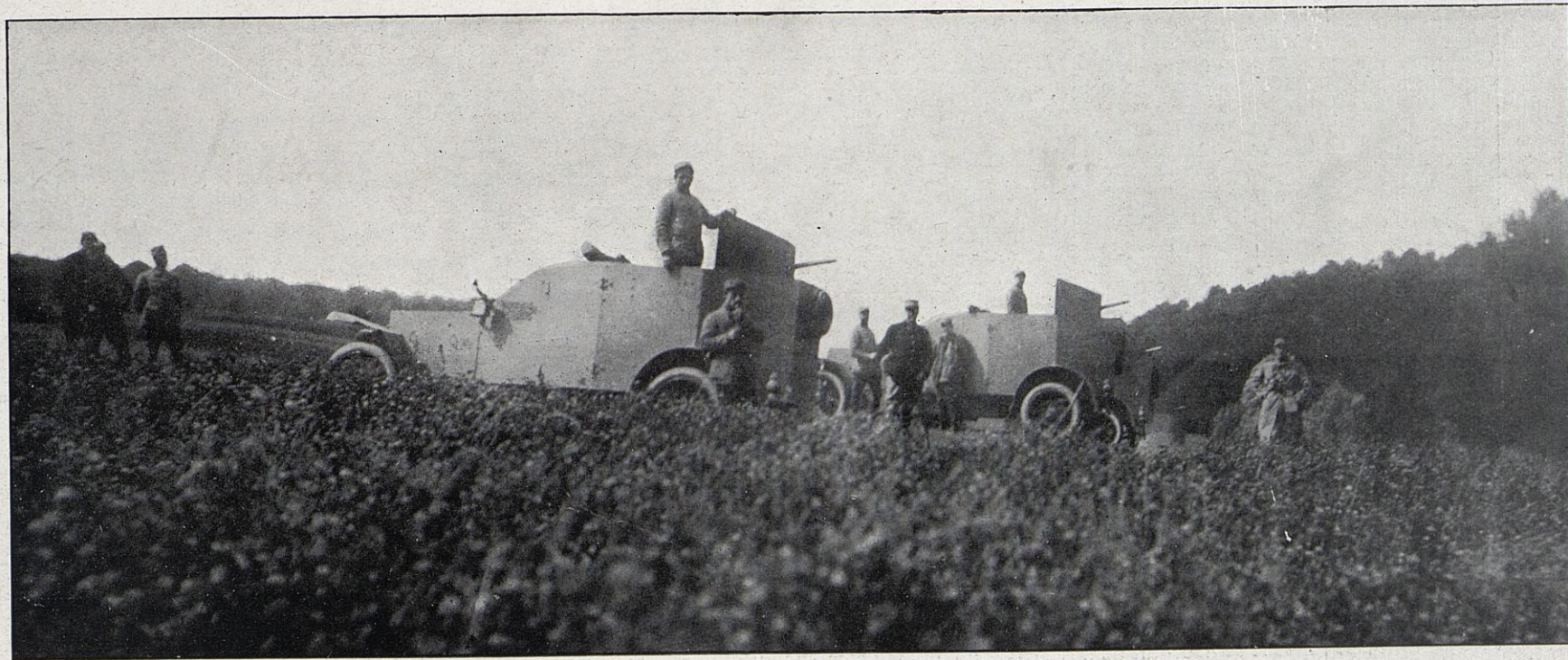
NOS AUTOS-CANONS EN ALSACE. — Armes redoutables, et d'ailleurs redoutée des Allemands, ces autos-cannons dont voici une section dans le plus pur paysage alsacien. Ils peuvent atteindre une vitesse de 60 kilomètres à l'heure et tirent une bonne moyenne de vingt coups à la minute. On peut croire que leur petit obus de 47,5 mm n'est guère populaire chez les soldats allemands!
