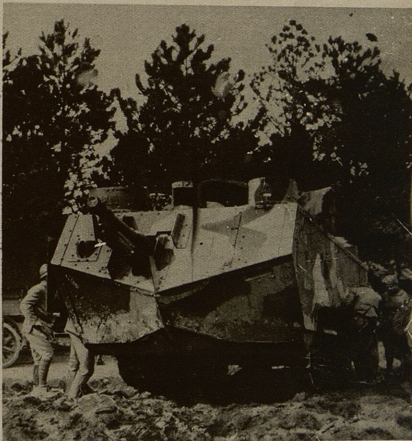
Cette photographie montre un « tank » en action ; l'engin traverse une tranchée, son avant grimpe le talus ; les canons, dont il est armé, sortent de la coupole de protection.
