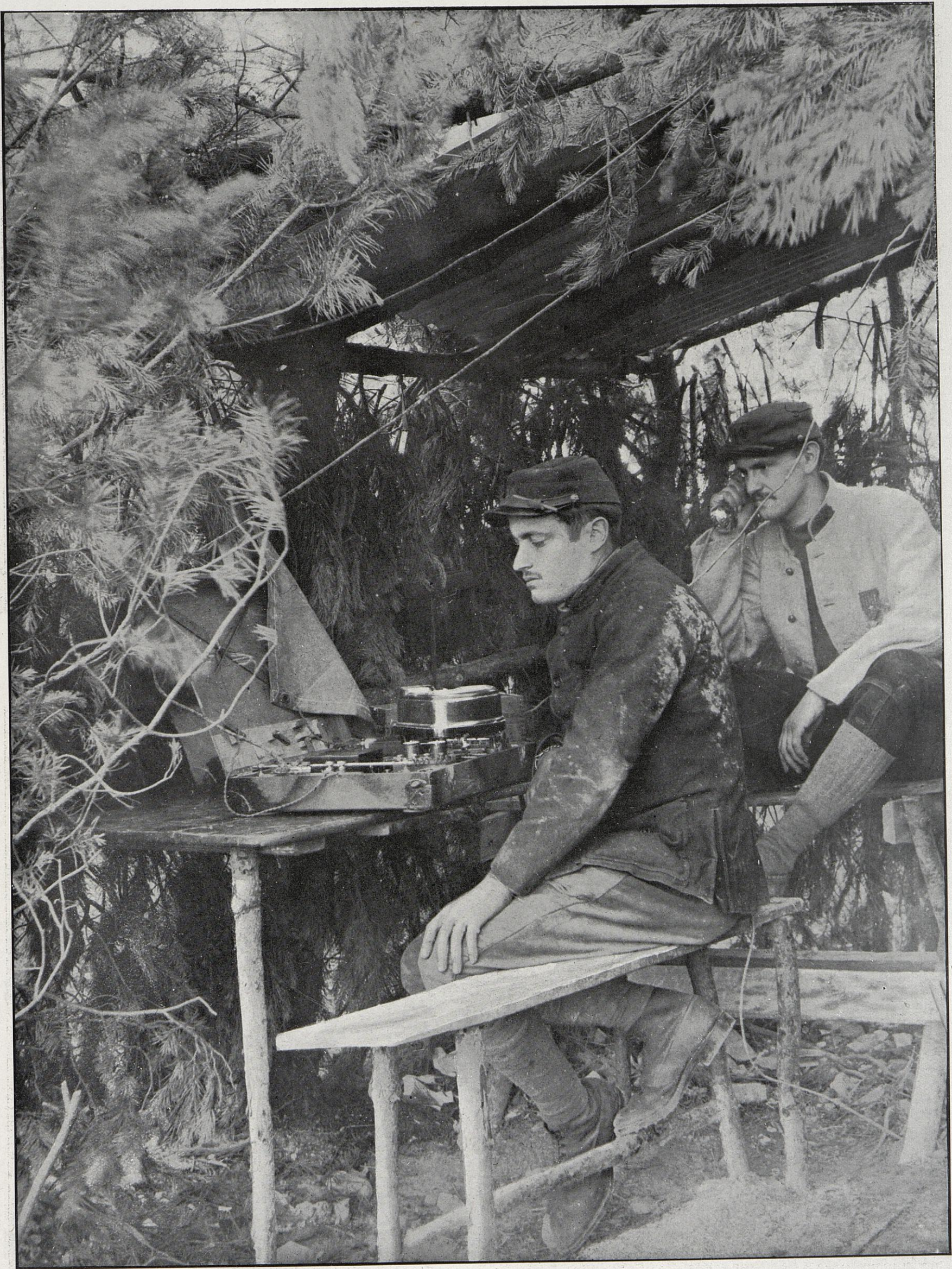
LES NOUVELLES INVENTIONS EMPLOYÉES POUR LA GUERRE. — Poste de télégraphie sans fil, avec combinaison téléphonique accouplée.
