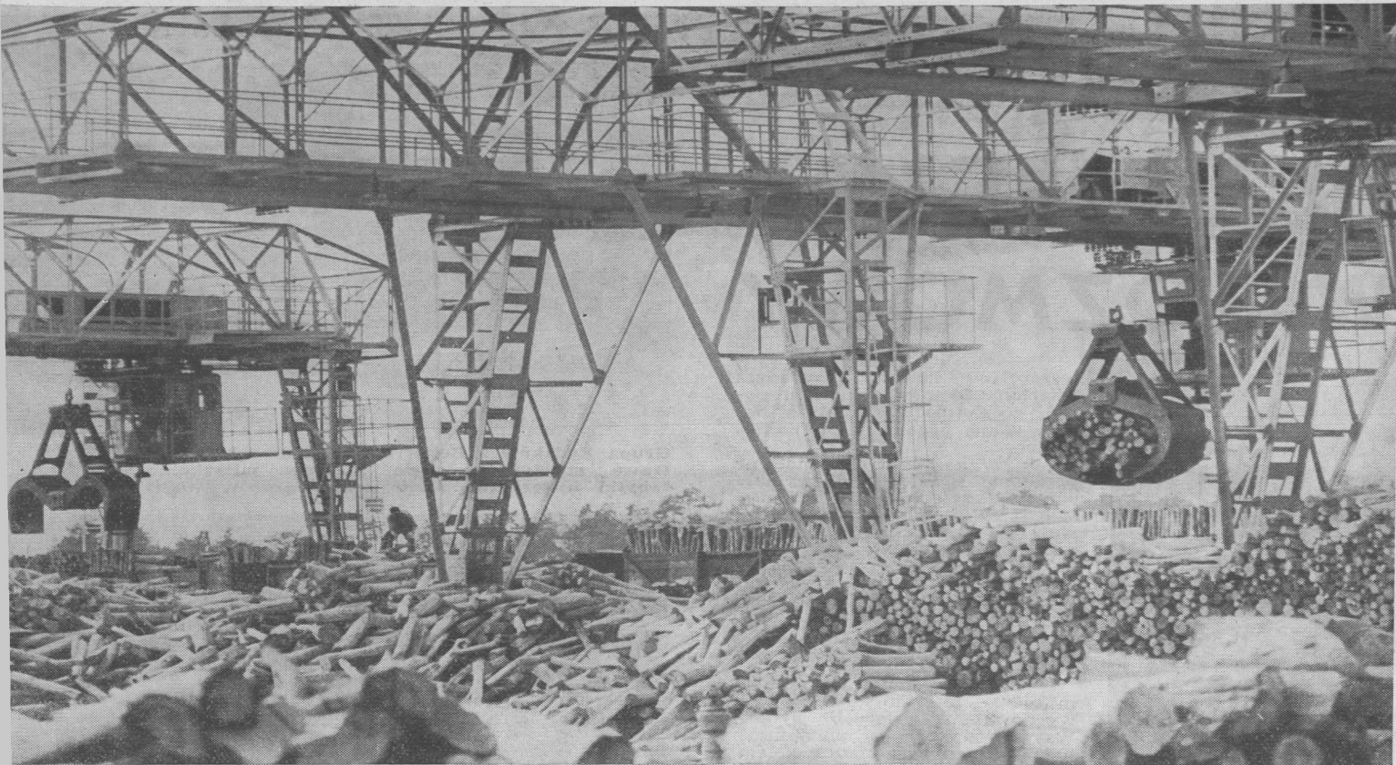
Na zdjęciu z lewej: pierwszy etap pracy na terenie fabryki — zmechanizowany przeładunek surowca drzewnego
