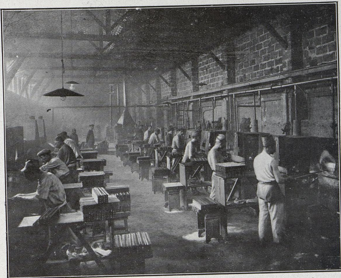
Trempe des bandes de mitrailleuses (Usine de Lyon-Vaise).
