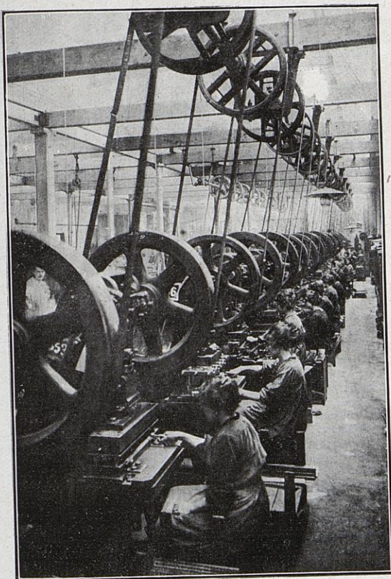
Emboutissage des bandes de mitrailleuses.
