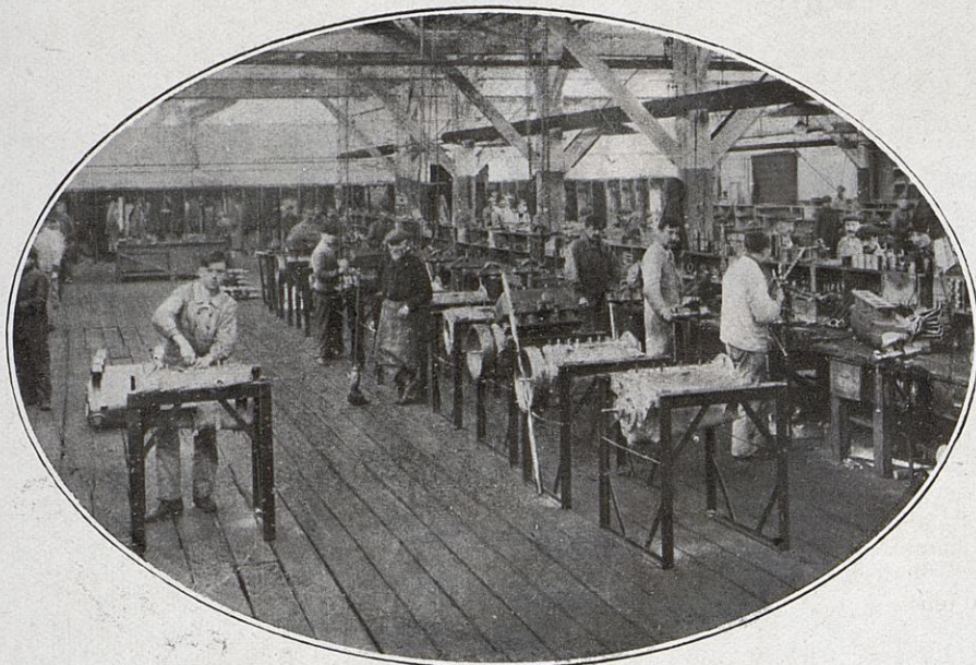
Le montage des moteurs d'automobiles.
