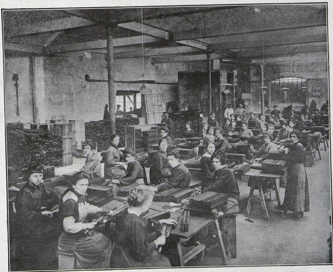
Ebarbage des bandes de mitrailleuses (Usine de Lyon-Vaise).
