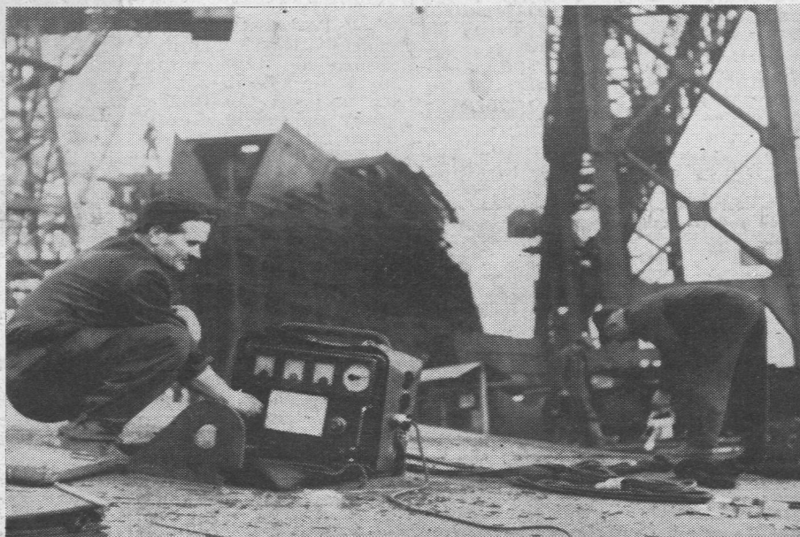
Un par un, les éléments en acier qui composeront la coque de ce futur bateau de 10.000 tonnes, en construction dans les chantiers de Gdansk, sont passés aux rayons X. Toute faille du métal sera automatiquement décelée et la pièce remplacée.
