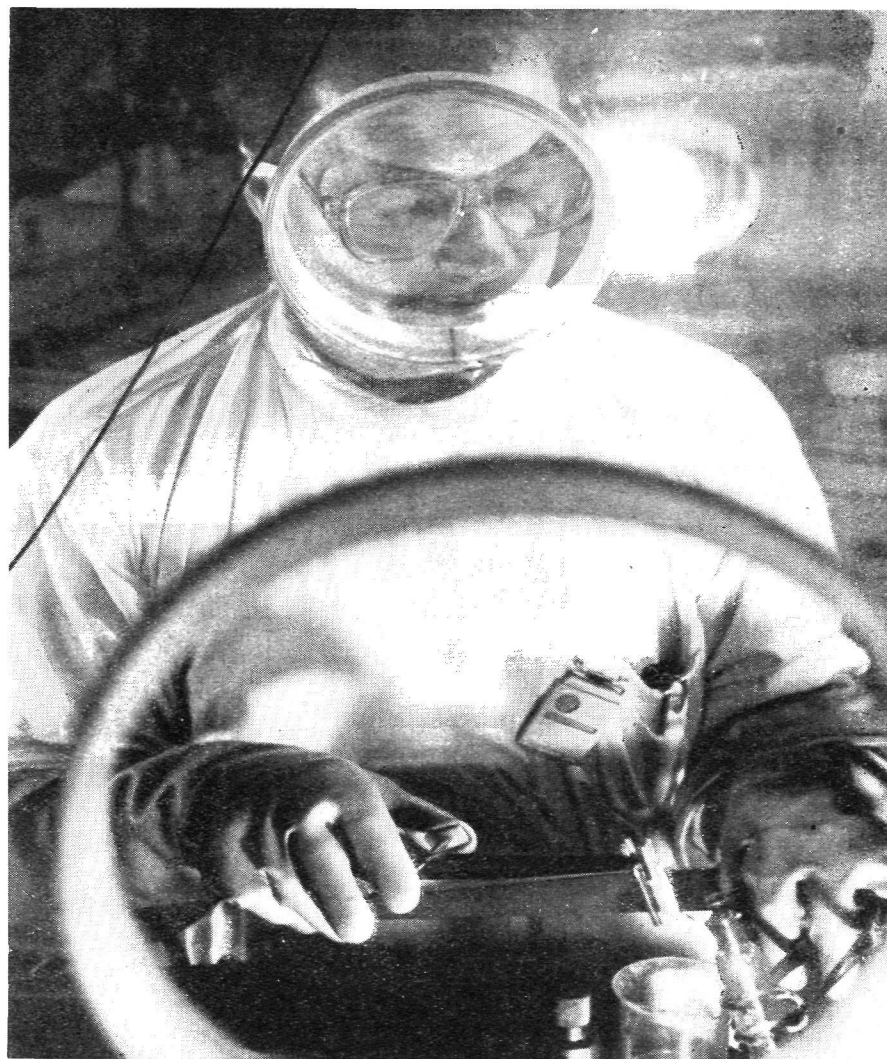
Fadanie izotopów promieniotwórczych wymaga wielkiej ostrożności i sprawnego operowania „sztucznymi rękami”, bez których praca jest niemożliwa
