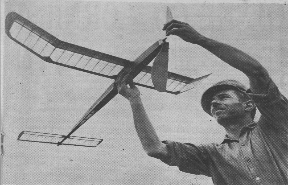
Skrzydła wygięte ku górze dla lepszej statyczności 420 g wagi, 34 dm 2 powierzchni nośnej (skrzydła i ster), śmigło złamane w połowie, prostujące się i usztywniające pod wpływem siły odśrodkowej. Oto najnowszy model konstrukcji pana Markuszewskiego. Na próbnych lotach spisał się doskonale
